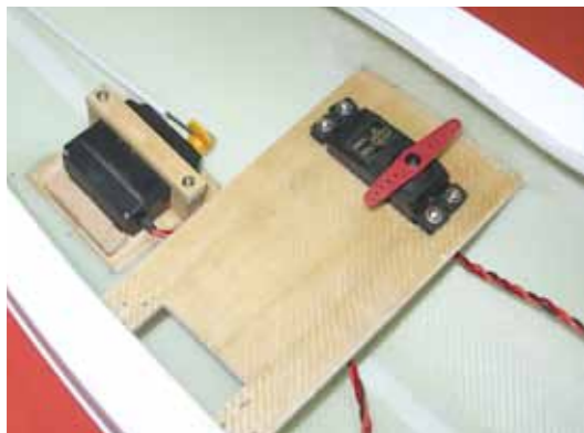
Das Servobrett wurde möglichst tief in den Rumpf eingeharzt, um später noch einen Cockpitausbau realisieren zu können. Das Schleppkupplungs servo sitzt unmittelbar davor auf der Rumpfunterseite
