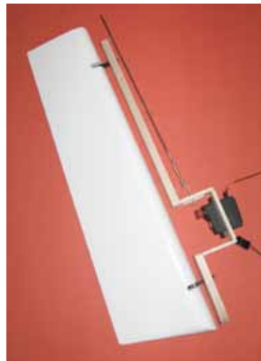
Die Höhenruderanlenkung erfolgt im Rumpffinnern. Das Servo sitzt in der Seitenruderabschlussleiste und die Anlenkung erfolgt geradlinig nach oben
