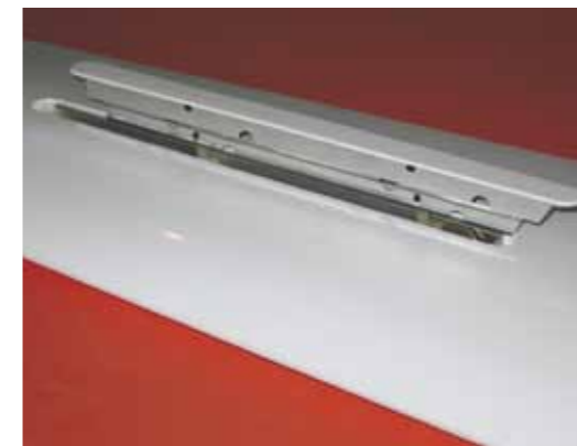
Die Störklappen sind flugfertig eingebaut und mit Abdeckungen versehen
