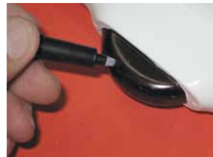
Der Rumpf enthält eine angeformte Rundung für das Spornrad, das mit einem schwarzen Permanentmarker imitiert wurde
