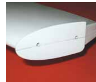
Die Störklappen sind flugfertig eingebaut und mit Abdeckungen versehen
