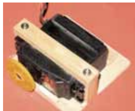
Die Schleppkupplung wurde im Rumpfboden realisiert, deshalb wurde eine schraubbare Halterung für das liegende Kupplungs servo gebaut
